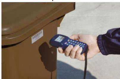
Il Sistema prevede che ad ogni contenitore (carrellati o secchielli) sia associato un codice identificativo contenitore univoco (tipicamente composto da 16 caratteri) con una numerazione progressiva e/o con una numerazione "parlante". Esso viene letto da un operatore ecologico all'atto del prelievo del rifiuto
