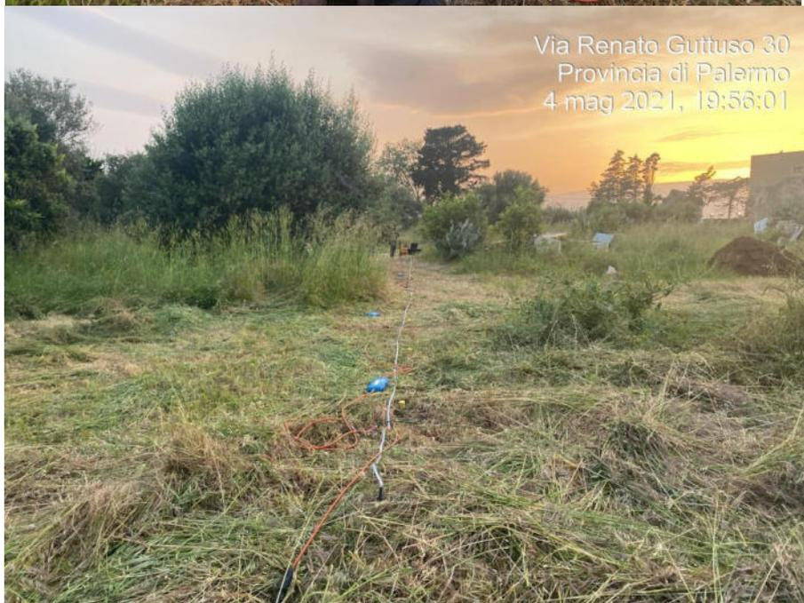
**Foto 1:** Stendimento della prova MASW S1 (end shot 1)
